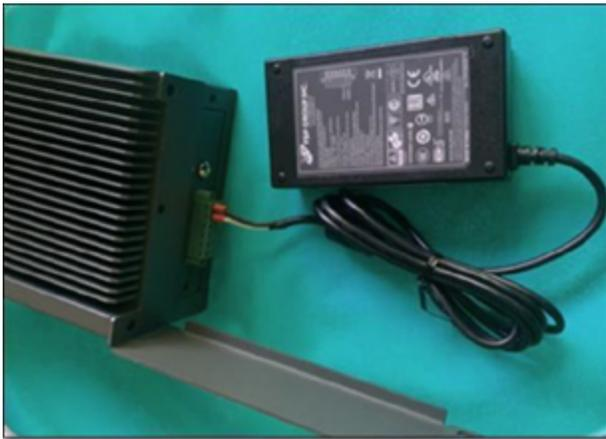
Stecken Sie dann das eine Ende des Wechselstromkabels (mitgeliefert) in das Netzteil und das andere Ende in eine Netzsteckdose.
