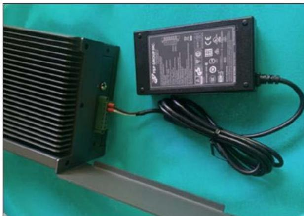
Stecken Sie dann das eine Ende des Wechselstromkabels (mitgeliefert) in das Netzteil und das andere Ende in eine Netzsteckdose.
