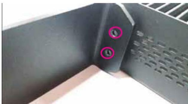
2. Setzen Sie zwei Schrauben auf jeder Seite ein und ziehen Sie sie mit einem Schraubendreher fest, um die Halterungen zu sichern.
